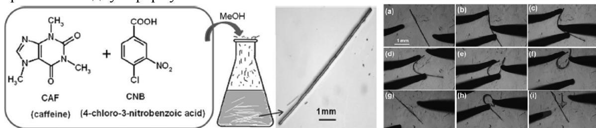
Подобные эластичные объекты могут найти применение как гибкие одномерные волноводы, ионные каналы, а также в гибкой фотоэлектронике. Заметим, что молекулярные кристаллы обычно хрупкие или мягкие (т.е. раскалываются или подвергаются пластической деформации), но не упругие.
